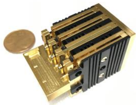
Assieme di 4 blades che comprende 16 canali radiofrequenza, comprensivo di parte della rete di beamforming .
